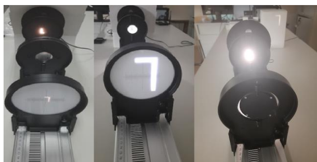
Рис. 2. Утворення дійсного зменшеного та збільшеного перевернутого зображення літери L та дійсне зображення у сферичному дзеркалі.
